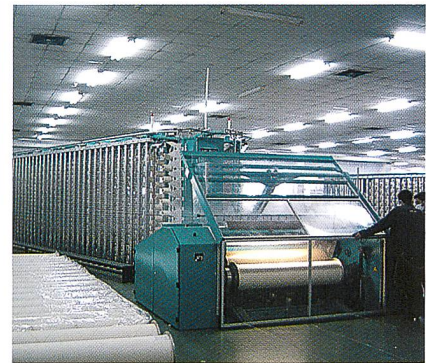
Abb. 3. Färbebaumzettelmaschine mit der neuen Wickeldichtenregelung
