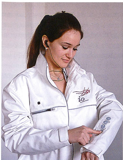
GPS/Galileo-Demo-Jacke mit stofffester Tastatur
