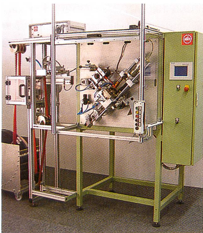
Abb. 6: Der Ablängautomat UV60-U
