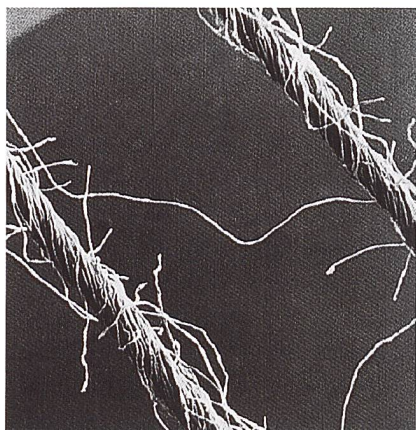
Abb. 2: Struktur des Rotorgarnes
