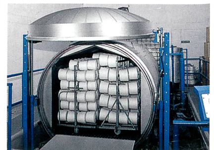
Abb. 2: Seit die Vardhman-Gruppe Garn konditioniert, wurde eng mit XORELLA zusammengearbeitet, dem Entwickler und Marktführer dieser Technologie. «Jedes Garn muss konditioniert werden, sonst gibt es Probleme», sagt S.P. Oswal. «Das indische Klima ermöglicht keinen Rückbehalt von Feuchtigkeit im Garn, es ist zu heiss.» Bild: Xorella AG, Wettingen (CH)
