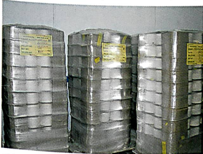
Abb. 3: 99 % aller Garne werden konditioniert, ausser Polyester- und Acrylgarne. Nach dem Konditionieren werden die Garne sofort in Folien verpackt und geben zur Weiterverarbeitung. Bild: Xorella AG, Wettingen (CH)
