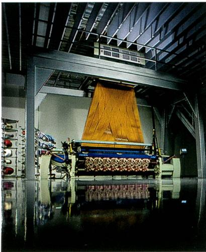
Abb. 3: Variante mit Jacquardmaschine
