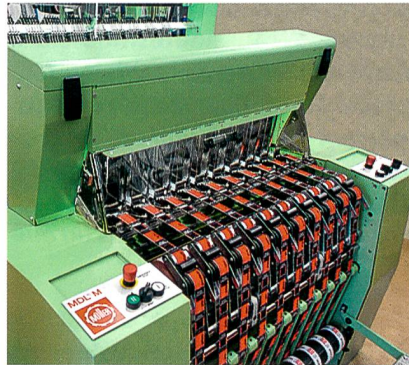
Abb. 3: MDLM – harnischlose Webmaschine für jacquardgemusterte Etiketten
