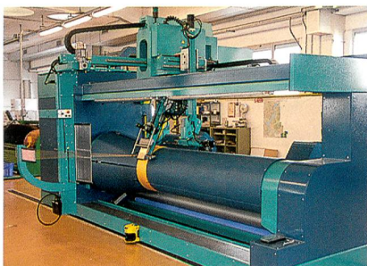
Abb. 2: VERSOMAT Ansicht Schärseite mit Geleseevorrichtung
