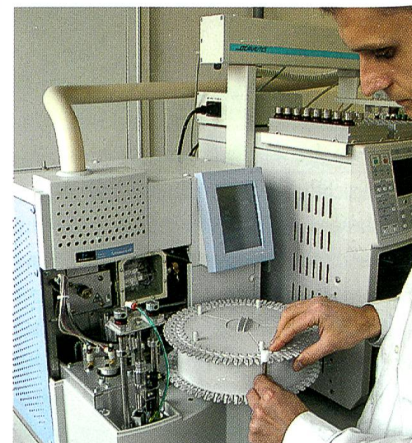
Qualitativer und quantitativer Nachweis von Geruchssubstanzen auf Textilien mittels Gaschromatograph mit Massenspektrometer Schweissgeruchsbildung. Hierzu wird die textile Geruchsanalytik nach in-vivo Trageversuchen mit Probanden durchgeführt.
