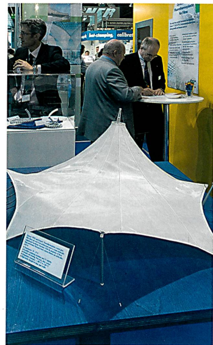
Buildtech – PTFE beschichtete Glasgewebemembrane – Dyneon, Quelle: Messe Frankfurt Exhibition GmbH/ Jean-Luc Valentin
