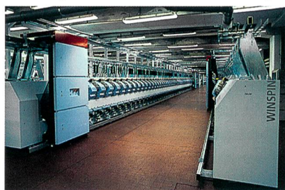
Die Produktionsanlage: «Beispielsweise ersetzen 48 Positionen bis zu 1'000 Ringspinnspindeln im Strickgarnbereich und bis 2'000 Spindeln im Webgarnbereich»
