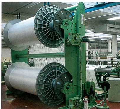
Abb. 2: Separates Kettbaumgestell, 2-bäumig für Förderbandgewebe
