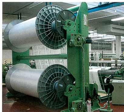
Abb. 2: Separates Kettbaumgestell, 2-bäumig für Förderbandgewebe
