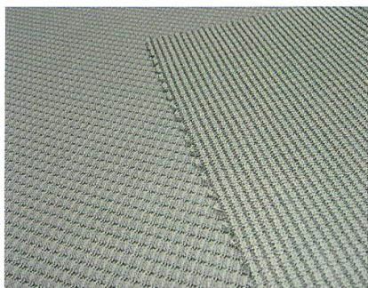
Abb. 1: «e1» – Kollektion Winter 08/09 Christian Eschler AG, Bühler/CH; Eschler-Maschenstoff mit Karbon, antistatisch und sehr leicht (120 g/m 2 )
