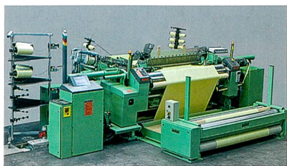
Abb. 4: Stangengreiferwebmaschine für Schwergewebe, Quelle: Dornier
