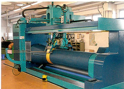
Abb. 2: VERSOMAT Ansicht Schärseite mit Geleseevorrichtung
