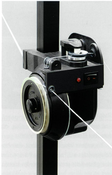
Abb. 2: Die rechnergesteuerte Fadenbremse AccuTense
