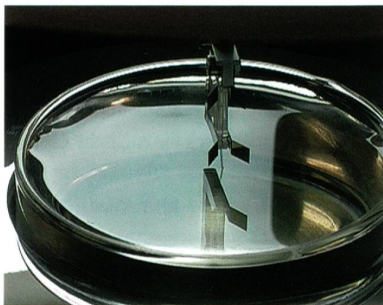
Vollautomatische Reihen-Benetzungsmessung von Einzelfasern
