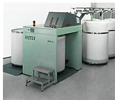
Abb. 3: Die neue Einkopf-Strecke SB-D 11
