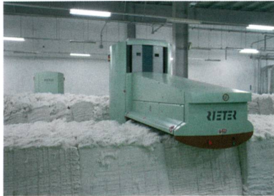
Abb. 1: Der automatische Ballenöffner UNIfloc A 11
