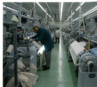
Der Maschinenpark mit den neuen Greiferwebmaschinen sichert die Zukunft der Jenny Fabrics AG
