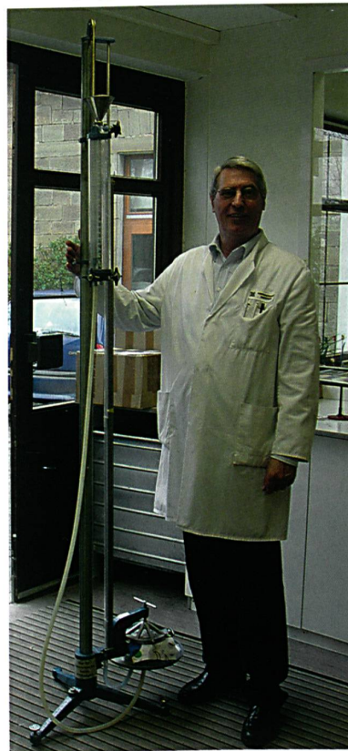
Abb. 1: Die «Wassersäule», in die Jahre gekommenes Messgerät zur Ermittlung der Wasserdichtheit von Textilien
