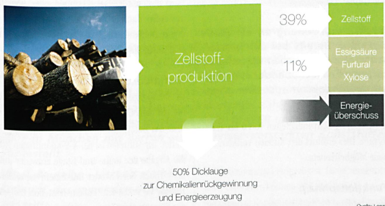
Abb. 3: Holz als Rohmaterial und Brennstoff für die Zellstoffproduktion
