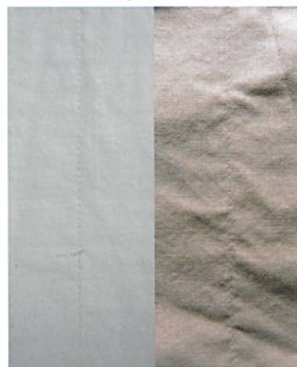
Abb. 2 und 3: Vergleich der Nahtoptik des besten und schlechtesten Nahtmusters nach der Wäsche (Verarbeitung unter idealen Nähbedingungen)
