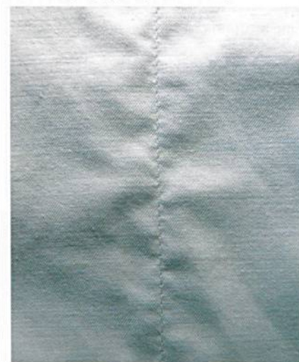
Abb. 4: Gekräuselte Nahtoptik nach der Wäsche durch zu hohe Fadzugskräfte
