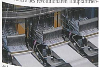
Abb. 2: Webstelle der neuen Nadelbandwebmaschine NH53 6/42
