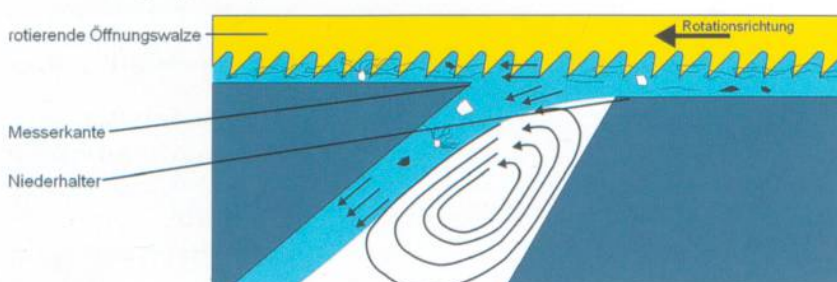
Abb. 1: Prinzip der Partikelabscheidung (bisherige Annahme)
