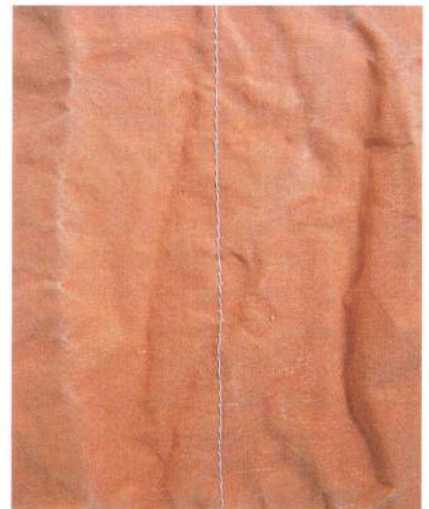
Abb. 1: Unakzeptable Nahtoptik nach der Wäsche (keine Bewertung nach dem Qualitätsstandard 702 möglich)
