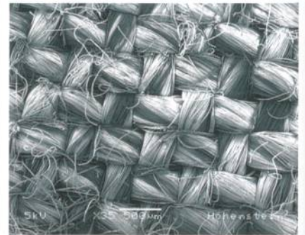
Gewebe aus 100 % Stapelfasergarn nach 100 Waschzyklen: Die Stapelfasern im Mischgarn weisen eine hohe mechanische Belastbarkeit auf
