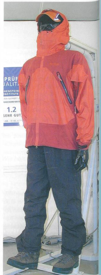
Abb. 5: Mit Hilfe der Gliederpuppe «Charlie» können an den Hohensteiner Instituten auch die Einflüsse der Körperbewegungen, der Umgebungstemperatur und des Kleidungschnittes auf den Tragekomfort gemessen werden
