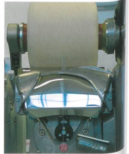
Abb. 7: Individuelles Kantendesign bei Färbespulen für Prozesskettenverkürzung
