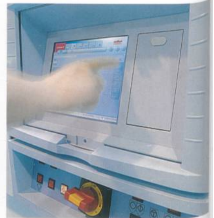
Abb. 6: Einfache und zentrale Einstellmöglichkeiten der Spulparameter am Informator
