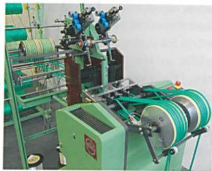
Abb. 1: Die neue Nadelband-Webmaschine für MultiSphere-Produkte NG3M
