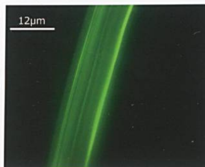
Abb. 2: Bei den neuartigen Wundauflagen wurden die Wirksubstanzen (grüne Fluoreszenz) mit Hilfe der Nanosol-Technik in eine Matrix aus Titandioxid eingebunden, Foto: Hohenstein Institute
