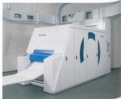
Abb. 2: TC- 07H mit Staubeinheit TC-SU
