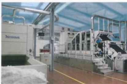
Abb. 1: Das neue Erko-Kardensystem im Fleissner-Technikum
