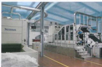
Abb. 1: Das neue Erko-Kardensystem im Fleissner-Technikum
