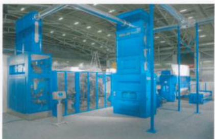
Abb. 3: Die kostengünstige Nadelvliesanlage AlphaLine
