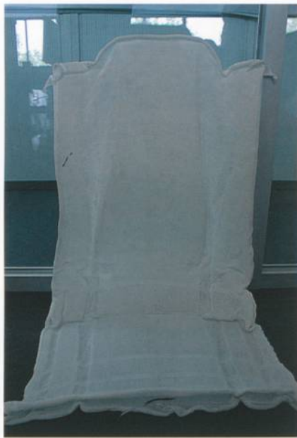
Abb. 4: Kindersitz mit eingearbeiteten Gelenken, Belüftungselementen und Seitenwangen
