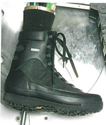
Abb. 2: Ein Fussmodell, das schwitzen kann, gibt Aufschluss darüber, wie Socke und Stiefel die Feuchtigkeit einlagern können
