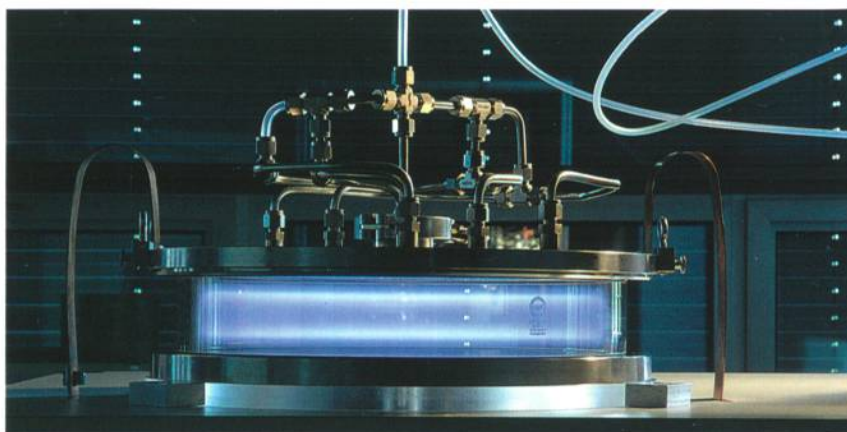
Abb. 1: Da Silberionen nicht nur Bakterien abtöten, sondern auch menschliche Zellen schädigen können, sind Schichten gesucht, die genau das therapeutische Fenster der Silberionen nutzen. Empa-Forschende entwickeln als Lösung neuartige nanostrukturierte Polymere mit eingebauten Silber-Nanopartikeln
