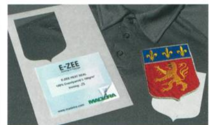
Abb. 2: E-ZEE Heat Seal – zuerst im passenden Zuschnitt mit dem Wappen verkleben
