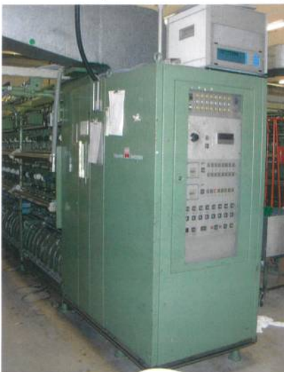
Org. Heberlein Spindeltexturiermaschine FZ-27
