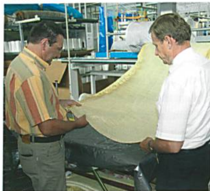
Impressionen der mtex 2008: sfi – die wissenschaftlichen Mitarbeiter Herr Herrmann (li.) und Herr Blechschmidt begutachten ein Triaxialgewirk für kunststoffverstärkte Bauteile im Fahrzeugbau
