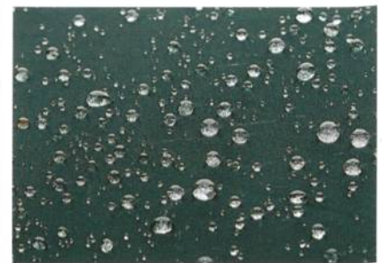
Abb. 2: Hochschmutzabweisende Fasern sind dank neuer Faserstrukturierung nun auch resistent gegen äusserliche Einflüsse wie Waschen oder Kratzen
