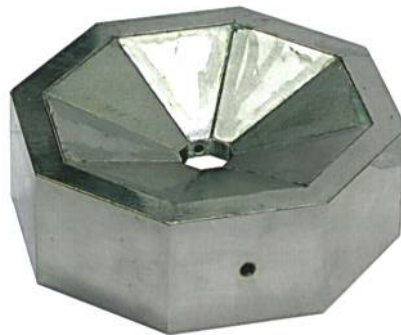
Abb. 4: Am ITCF entwickelte Hochenergie-Magnetfeldspule zur Faserstrukturierung; Bild: ITCF Denkendorf
