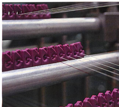
Abb. 3: Fadenführungsorgane mit offener, einfädelbarer Öse
