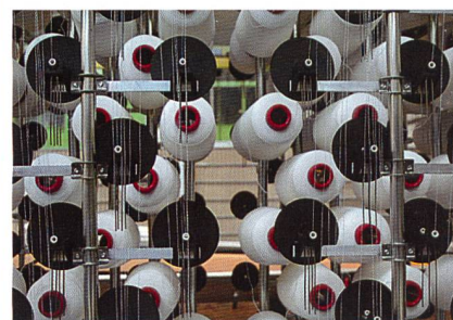
Abb. 3. Grosszügig bemessener Raum für den Materialwechsel an jeweils sechs Spulenplätzen des neuen Gatters
