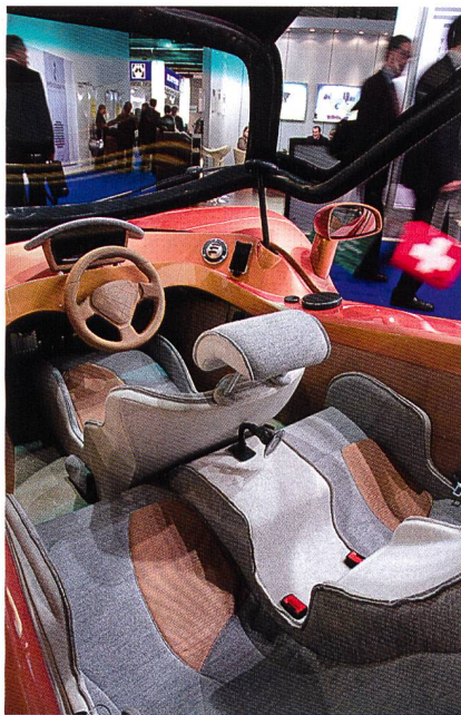
Abb. 4: Sitzformteile tragen zur Gewichtseinsparung im Automobilbau bei auf 30-35 Kilogramm erhöhen. Anteilig werden davon 50-60 % Vliesstoffe sowie Filze und 40-50 Prozent andere textile Flächengebilde sein. Experten gehen davon aus, dass zudem der Einsatz von Naturfasern bzw. Fasermischungen in
