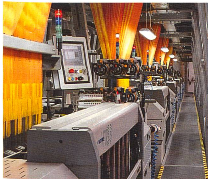
Abb. 3: VTR33 für italienischen Samt, installiert in Indien
