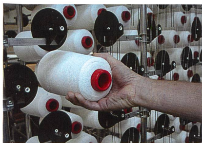
Abb. 4: Spulenwechsel am optimierten Gatter
