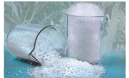
Abb. 2: Fasern aus Biopolymeren (PLA / Ingeo™) (Foto: Trevira)
