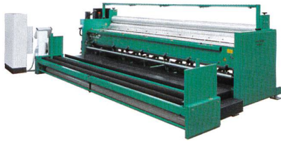
Abb. 1.: Gesamtansicht der Nähwirkmaschine MALIVLIES
