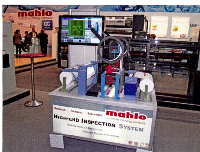
Abb. 1: Automatische Fehlerinspektion Webscan WIS-12
