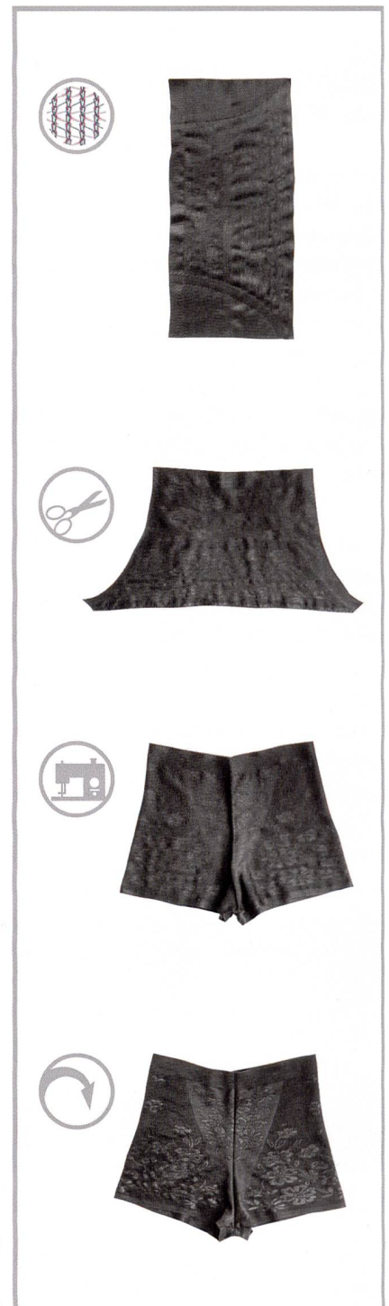
Abb. 3: Die Arbeitsschritte zur Herstellung der 3D-Shape-Höschen
