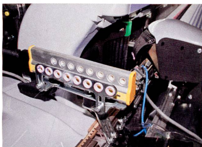
Abb. 1: Der Maestro-Schussfadenwächter an der Greiferwebmaschine Silver 501
