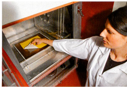
Abb. 4: Um das Wärme- und Feuchtmanagement der Funktionsmuster zu ermitteln, die aus dem neuartigen Garn produziert wurden, nutzen die Hohenstein Wissenschaftler das Hautmodell. ©Hohenstein Institute
