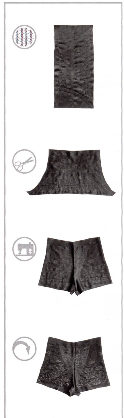
Abb. 3: Die Arbeitsschritte zur Herstellung der 3D-Shape-Höschen
