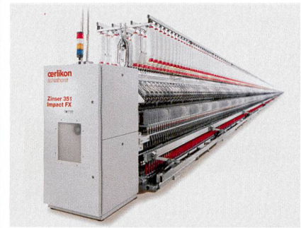
Abb. 2: Zinser Kompaktspinnentechnologie Impact FX
