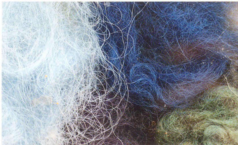
Abb. 9: Farbnuancen von Indigo unter Zusatz unterschiedlicher Metallsalze.
