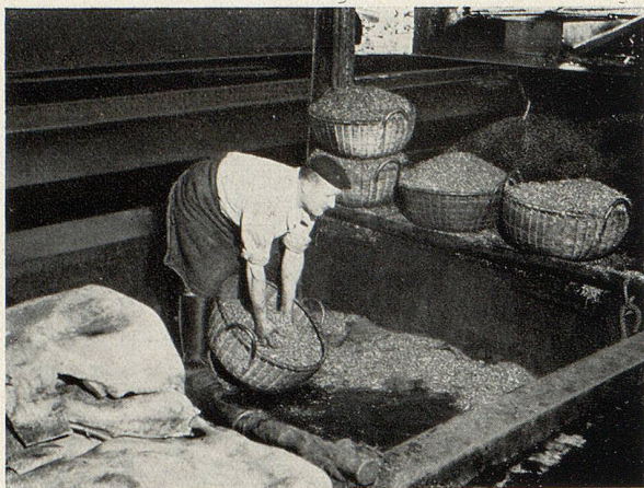
Die ursprüngliche Gerbmethode: In tiefen Gruben wird Haut für Haut, mit Zwischenlagen duftender Eichenlohe, aufgeschichtet
